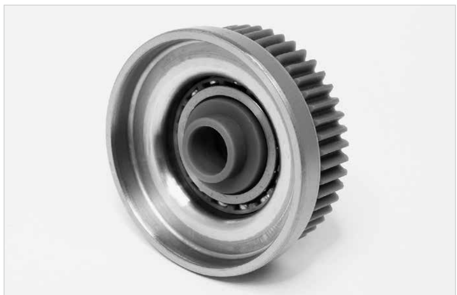
Sonderlager können so konstruiert werden, dass sich anstelle des Außenrings ein großes Zahnrad befindet, das die Kraft überträgt. Es übernimmt dabei die Laufbahn der Wälzkörper, weist aber gleichzeitig die notwendige Formgebung auf, um die Kraft auf die nächsten Bauteile zu übertragen. Durch diese Integration wird effizient Bauraum gespart, ohne Einbußen der Lagerfunktion und Haltbarkeit.
